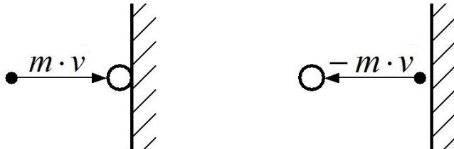
Abbildung 2.6. Impulsübertrag p an einer Wand durch einen elastischen Stoß.
